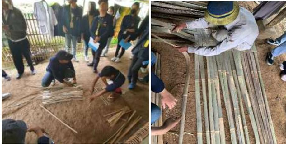
Gambar 2. Proses Pemotongan, Pembelahan dan Pengiratan
